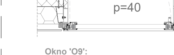
Okno "O9": Dim. šxh 1,30 m x 2,20 m, p=0,40 m.
